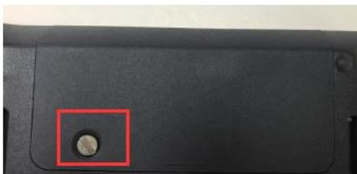
Снять крышку и вынуть батарею.
