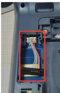
В отсеке для ФН расположен шлейф для подключения ФН к системной плате ККТ.
